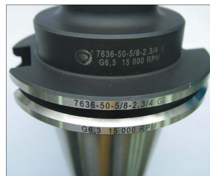
Rys. 2. Przykład laserowego znakowania na trzpieniu frezarskim
