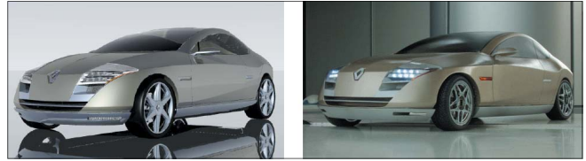
Rys. 5. Modele wirtualny i fizyczny (wykonany w skali 1:10 techniką Rapid Prototyping) prototypu nadwozia samochodu (oprac. zespół studentów pod kierunkiem dr. inż. M. Rychlika)
