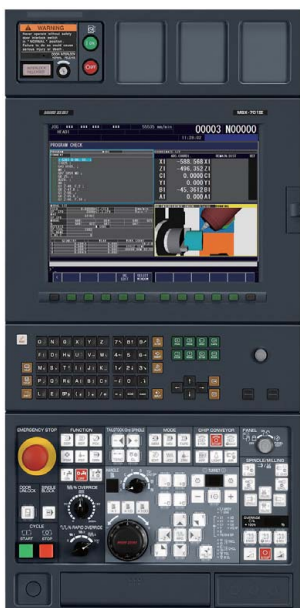
15-calowy panel operatorski do zintegrowanych centrów tokarsko-frezarskich i centrów poziomych
