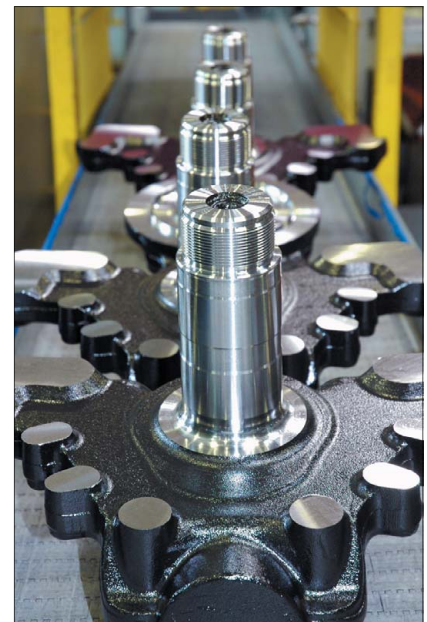
Rys. 4. Zwrotnica ze sworzniem skierowanym do góry przed tokarką
