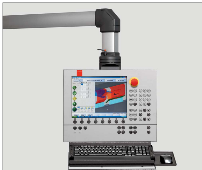
Rys. 2. Panel sterownika prasy Beyeler Xpert. Gięcie wykonywane po dotknięciu jednego przycisku
