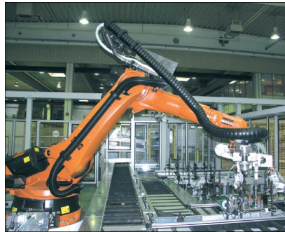
Rys. 2. Zintegrowana sprężyna odciągająca wytwarza odpowiednie napięcie wstępne, co zapobiega powstawaniu pętli na głowicy robota
