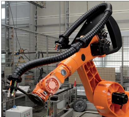
Rys. 1. „Triflex RS” to system prowadzenia przewodów równoległe do ramienia robota, poruszający się w kilku osiach, w sposób zapewniający oszczędność miejsca
