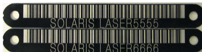
Rys. 4. Przykład laserowego znakowania na tabliczkach aluminiowych
