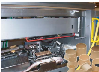
Rys. 1. Niewymagające smarowania łożyska ślizgowe z tworzywa sztucznego „iglidur” sprawdzają się doskonale w maszynach do przetwórstwa rybnego
