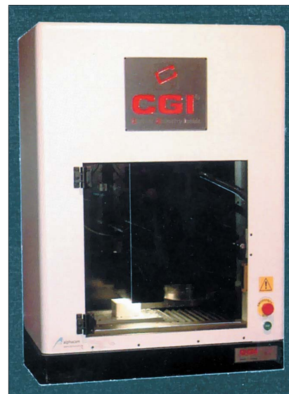
Rys. 7. Urządzenie CGI CSS 300 firmy CGI do inwazyjnego skanowania wyrobów
