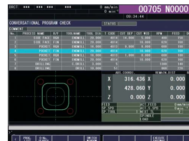
Funkcja bezpośredniego programowania operacji w menu konwersacyjnym; funkcja bezpośredniego zobrazowania w menu konwersacyjnym
