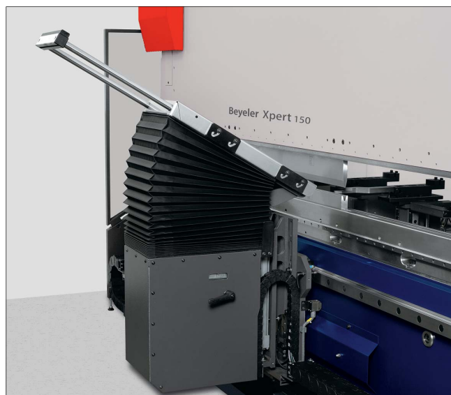
Rys. 3. Hydrauliczna oś H pozwala wyeliminować wszystkie przeciwigięcia
