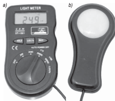
Fot. 1. Luksomierz DT-1301, a) miernik uniwersalny ze wzmacniaczem; b) głowica fotometryczna
