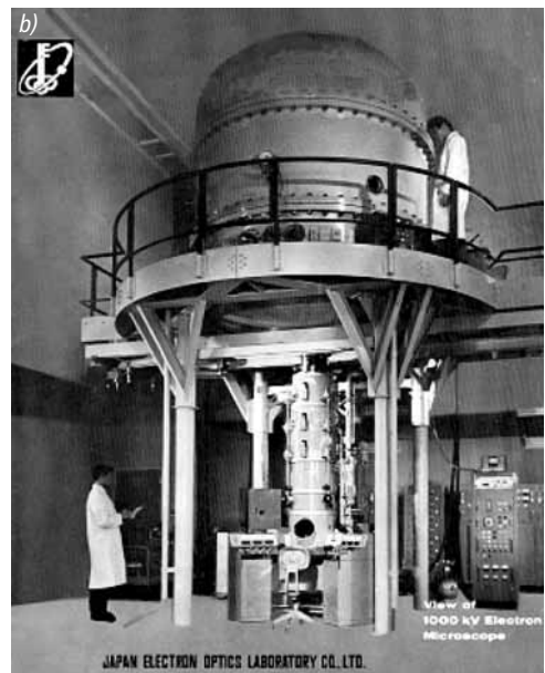
Rys. 3. Mikroskop elektronowy: a) typ JEM 2010, napięcie przyspieszające 200 kV; b) mikroskop wysokonapięciowy (1 MV) f-my JEOL: wewnątrz pojemnika widocznego w górnej części mikroskopu znajduje się działło elektronowe, w dolnej części – kolumna zawierająca układ optyczny mikroskopu.
