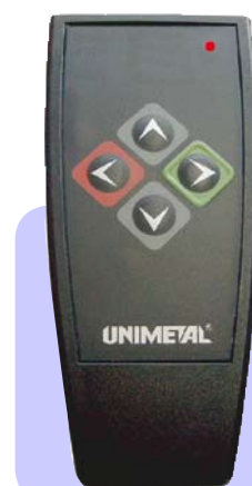
Rys. 2. Pilot zdalnego sterowania urządzenia rolkowego RHO-6
