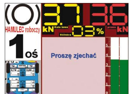
Rys. 7. Prezentacja wyników badania układu hamulcowego na urządzeniu rolkowym na ekranie – oś 1
