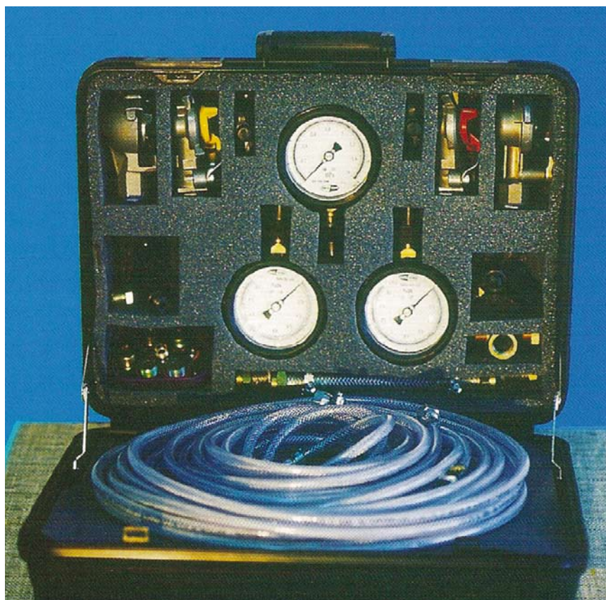
Rys. 2. Przenośny zestaw diagnostyczny (3-manometryczny) WZD-1 opracowany przez Przemysłowy Instytut Motoryzacji – Oddział w Łodzi (Źródło: Wabco)
