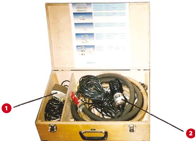
Rys. 5. Wyposażenie przyrządu do badania czasu reakcji hamulców firmy Wabco: 1 – włącznik pomiaru czasu, 2 – czujnik ciśnienia (Źródło: Wabco)
