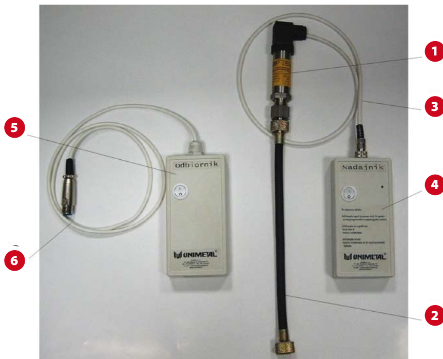
Rys. 3. Bezprzewodowe mierniki ciśnienia w instalacji powietrznej pojazdu (z radiowym przesyłem danych) firmy Unimetal: 1 – przetwornik ciśnienia, 2 – wąż gumowy ze złączem, 3 – przewód ze złączem wtykowym, 4 – nadajnik radiowy, 5 – odbiornik radiowy, 6 – przewód ze złączem wtykowym (Źródło: Wabco)
