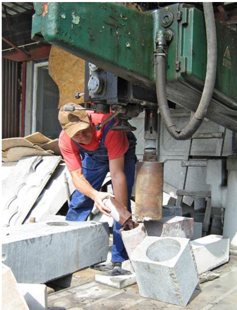
Rdzeń z wyciętych ścian wazonu wykorzysta się pod obrzeże chodnika
